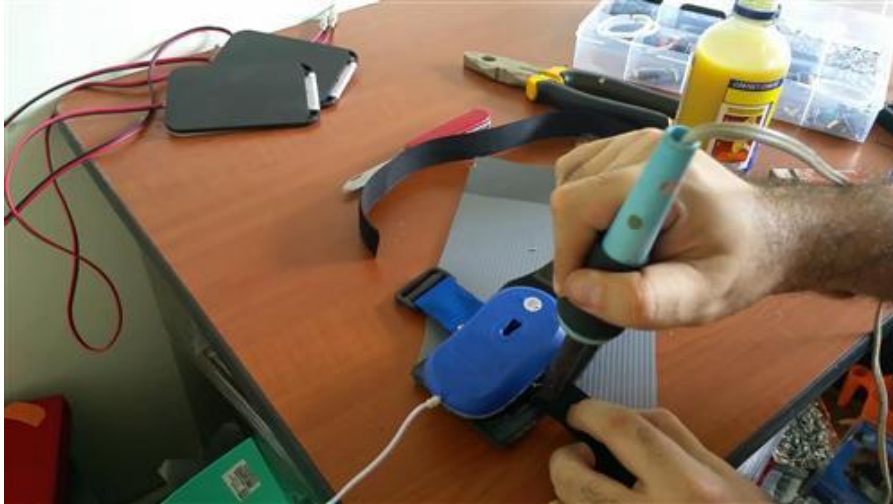
Fijando una brida para sujetar el ratón al pie.
