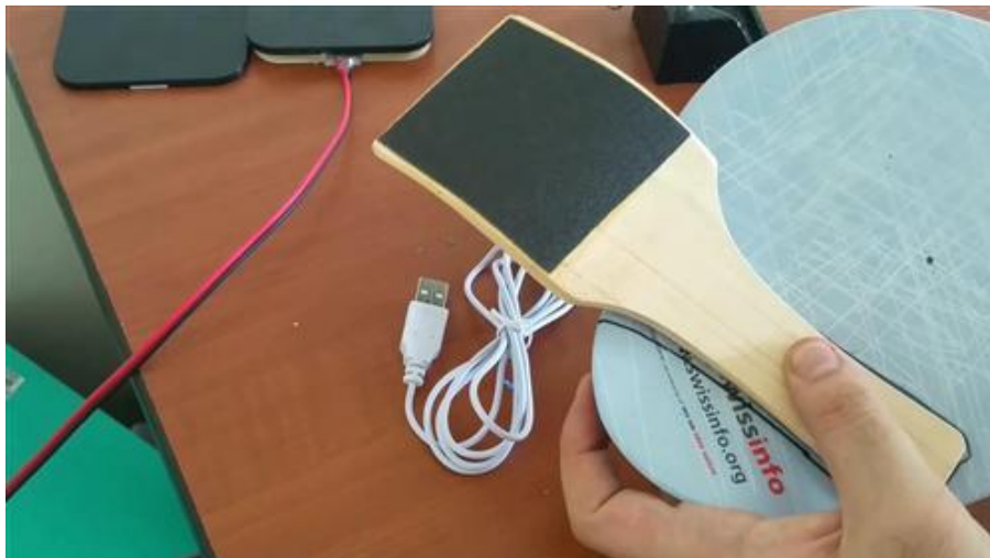
Recortamos un trozo de almohadilla (la parte deslizante) para pegarla en la parte inferior de la espátula para que deslice mejor.
