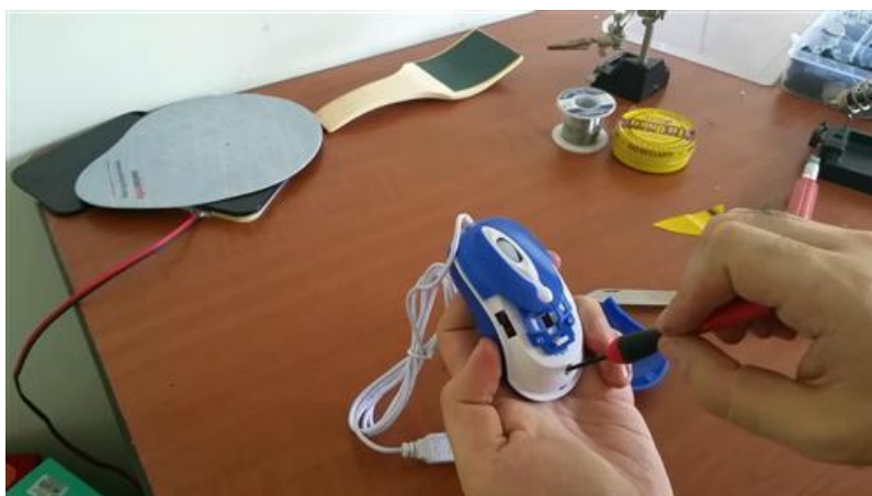
Desmontar el ratón para sacar pulsadores externos.
