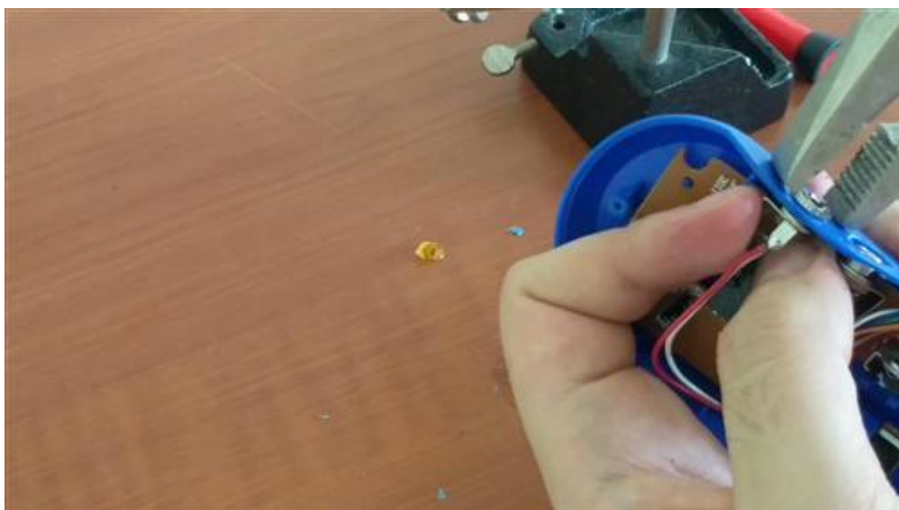
Fijando las bases a la carcasa.
