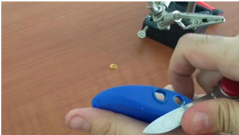
Agujeros para las bases en la carcasa del ratón.
